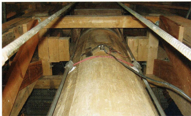
Bild 13. Stauchungs- und Schallemissionsmessung Fig. 13. Measuring of compressive strain and acoustic emission
